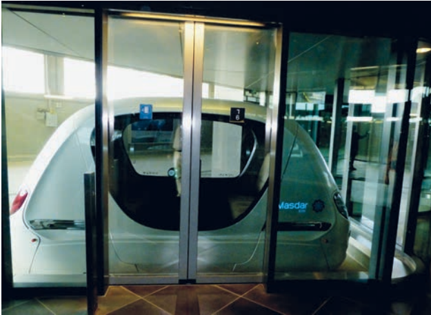
Abbildung 4: Eine neue Form des innerstädtischen Verkehrs wird in Masdar City mit dem Personal Rapid Transit (PRT) erprobt. Motorisierter Individualverkehr und auch ÖPNV sind in Masdar nicht vorhanden. PRT arbeitet über Magneten und Elektroantrieb, wird öffentlich bereitgestellt und kann von jedermann jederzeit kostenlos benutzt werden. Fahrwege und Stationen sind vorgegeben.
